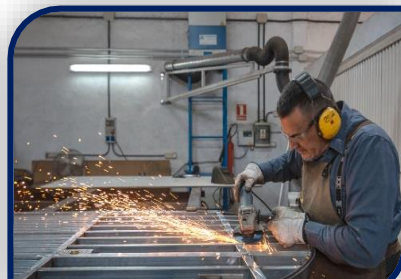
Creación de vallas y preparación de anclajes
