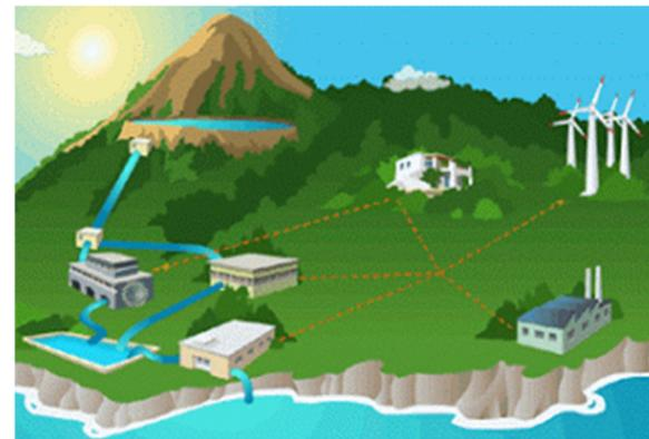
Fig. 43.- Esquema de la Central Hidroeléctrica de Gorona del Viento en El Hierro, aprovechando el relieve para gestionar la energía. Fuente: <http://geomadriles.blogspot.com/2014/03/la-isla-del-hierro-ejemplo-de.html>
